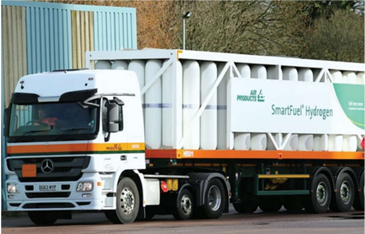
Figur 8. Exempel på tubtrailer för lagring och transport av komprimerad vätgas.
