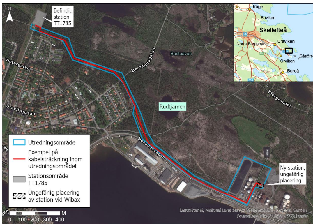
Figur 1: Karta med förslag på utredningsområde för planerad markförlagd 36 kV kraftledning mellan befintlig station och ny station vid Wibax verksamhetsområde. Kartan visar även ett exempel på kabelsträckning inom utredningsområdet.
