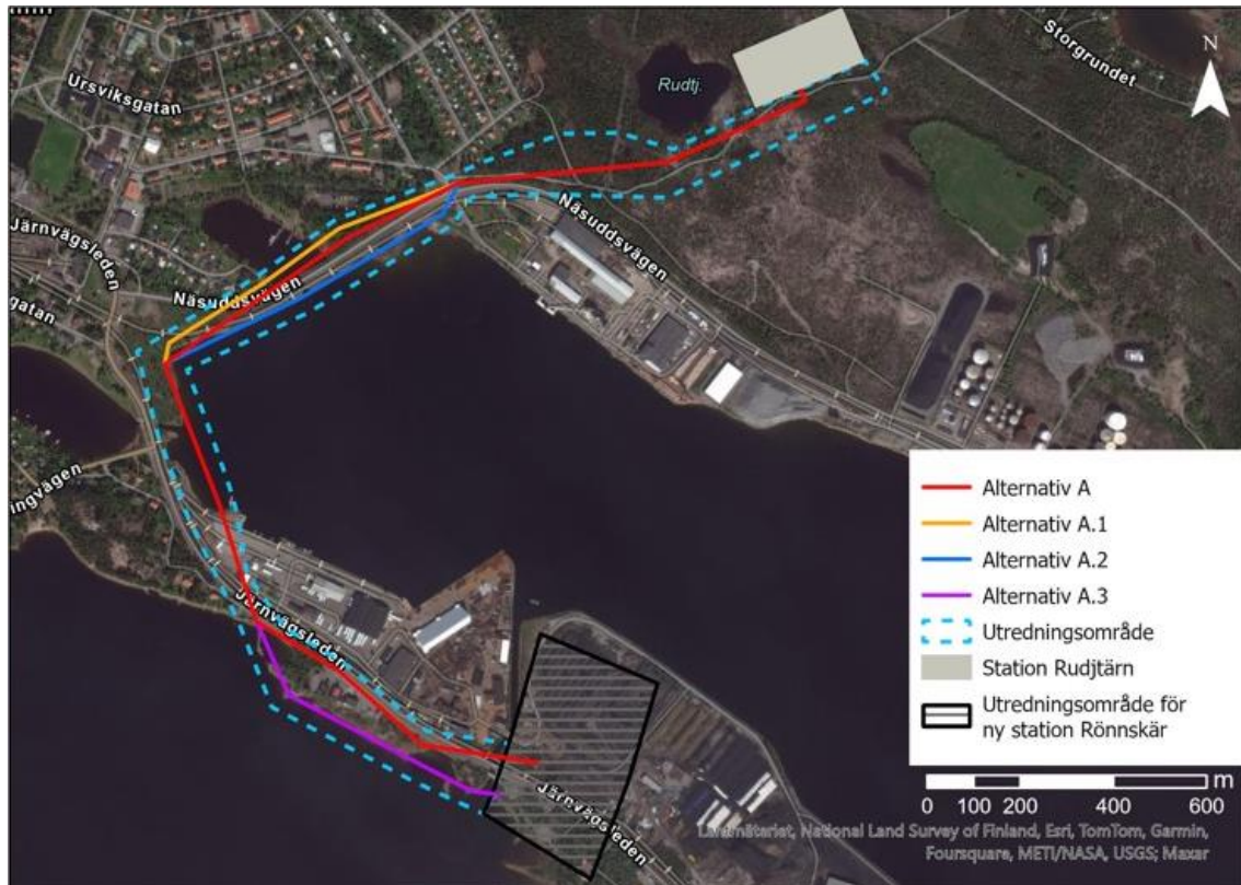
Figur 5. Karta med utredningsområdet för den planerade 170 kV-kraftledningarna mellan station Rudtjärn och ny station vid Rönnskär. Kartan visar även exempel på alternativa ledningssträckningar inom utredningsområdet.
