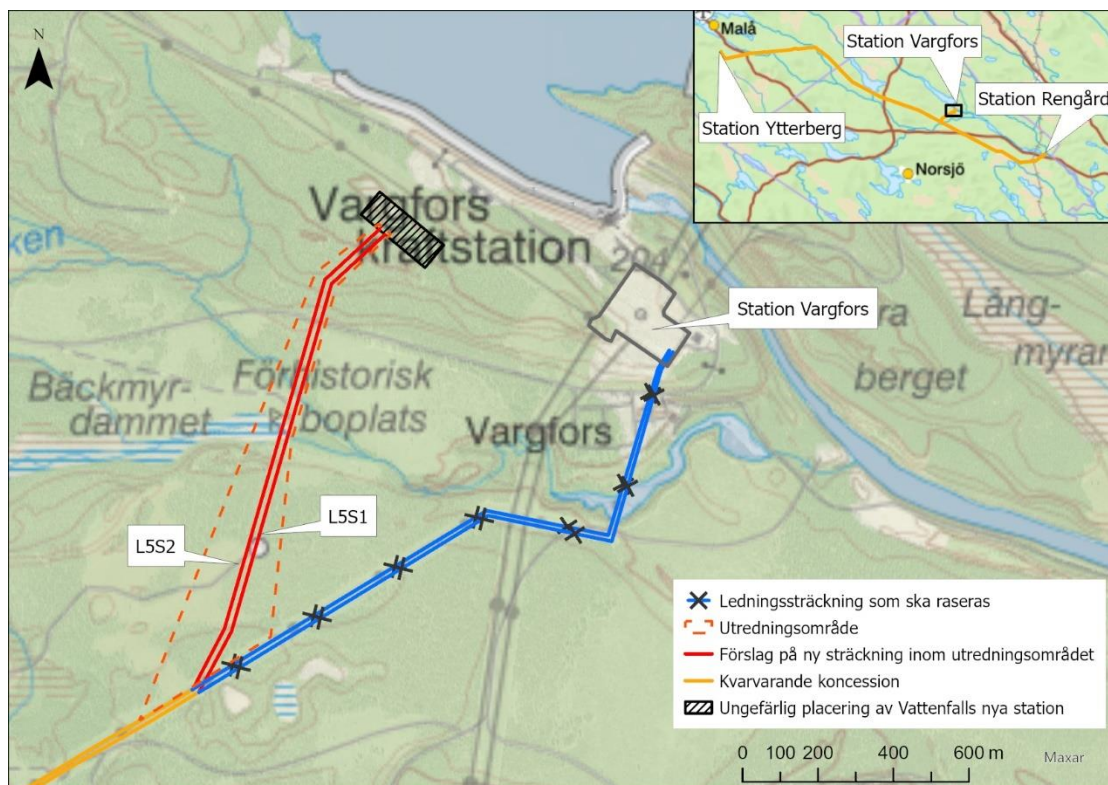
Figur 1. Översiktskarta med utredningsområdet för den nya sträckningen, förslag på ny ledningssträckning inom utredningsområdet och den motsvarande ledningssträckning som raderas.
